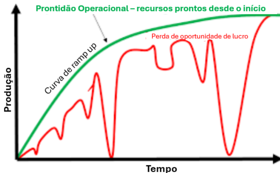
Figura 1: Curva típica de start up para a operação 2
